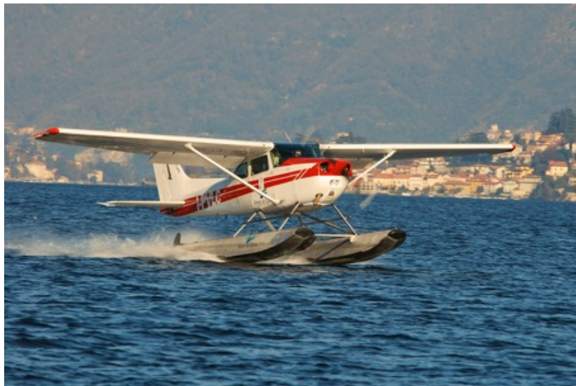
Figure 2 : monomoteur bi-flotteurs, ailes hautes Cessna 172
