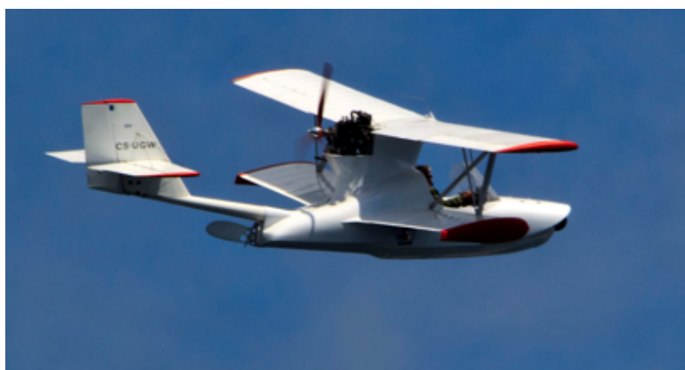
Figure 4 : hydroULM classe 3 amphibie à coque
